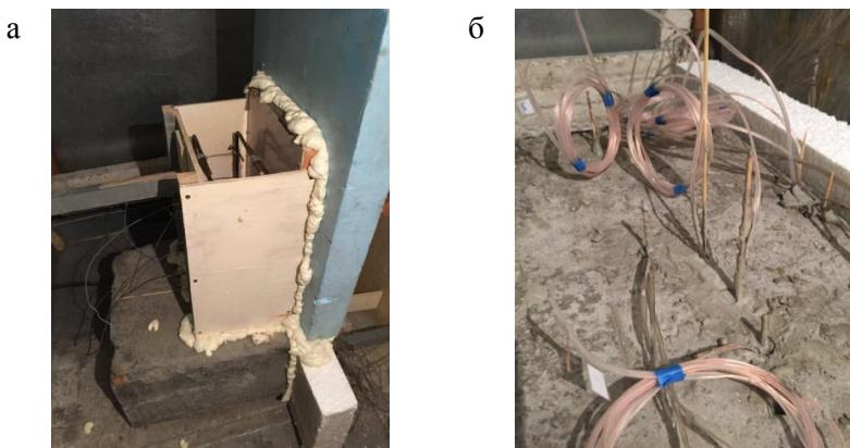
Рис. 1. Модель фрагмента колонны, бетонируемой на мерзлом перекрытии: а – общий вид модели; б – монтаж термо- и кондуктометрических створов
